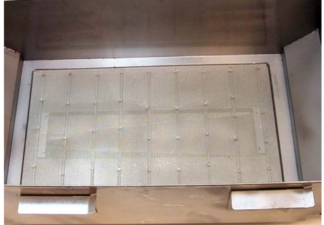
Ordnungsgemäß in der Filterwanne angebrachtes Tragitter.
