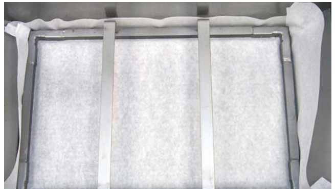
Korrekt auf dem Filterpapier in der Filterwanne angebrachter Niederhaltering.
